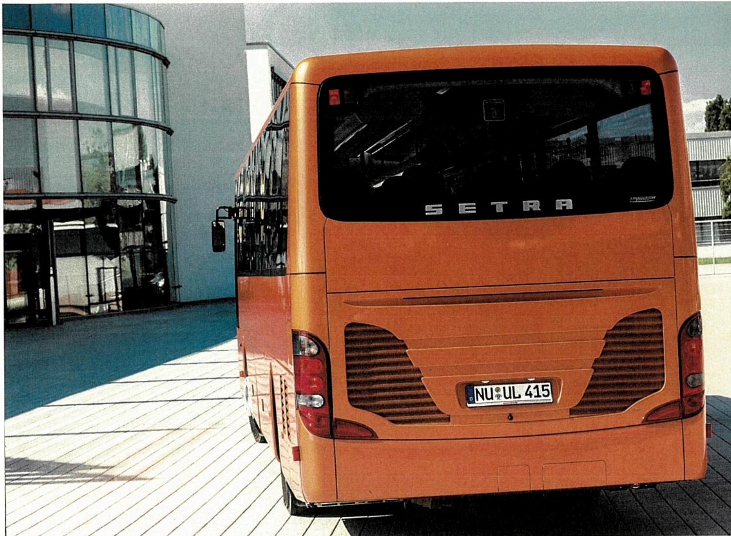
Im Heckbereich ist zum normalen UL so gut wie kein Unterschied festzustellen. Das linke Gitter ist ausschließlich aus optischen Gründen verbaut
