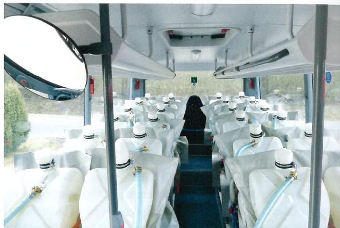
Links: Die Sitze sind auf Podesten montiert, sodass vorne nur drei flache Stufen zu erklimmen sind. Der große Spiegelarm ist zwar einfach gestaltet, trägt jedoch erheblich zur guten Sicht bei. Rechts oben: Der zeckmäßig gestaltete Innenraum ist mit Polstersitzen vom Typ Transit ausgestattet. Rechts unten: Wassertanks simulierten auf der Testfahrt eine praxisgerechte Auslastung.
