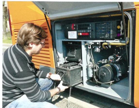
Blick in die Elektrik hinten rechts: Herausziehbare Batterien, Schalttafel mit größtenteils Schmelzsicherungen, rechts unten die Zusatzheizung von Spheros.
