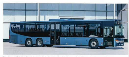
Der Vordereinstieg kann beim S 418 LE entweder 1.150 mm oder 900 mm breit ausgeführt werden. In der Mitte hat der Kunde die Wahl zwischen 1.150 mm und 1.380 mm. Beide Einstiege sind selbstverständlich stufenlos.
