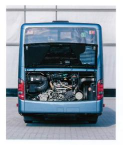
Der Daimler-Diesel OM 470 ist mittig im Heck längs stehend verbaut. Er ist in Leistungsstufen von 265 kW [360 PS] oder 290 kW [394 PS] erhältlich. Zur Kraftübertragung dient in der **Basisversion** das manuelle Sechsgang-**Schaltgetriebe** TGO 210. Als **Alternativen**
