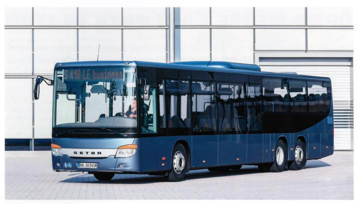
Der Setra S 418 LE Business ist bei Radständen von 7.040 mm + 1.600 mm exakt 14,64 m lang. Standard ist die so genannte 100%-Bereifung 295/80 R 22,5, verfügbar ist aber auch 275/70 R 22,5. Fotos: Daimler
