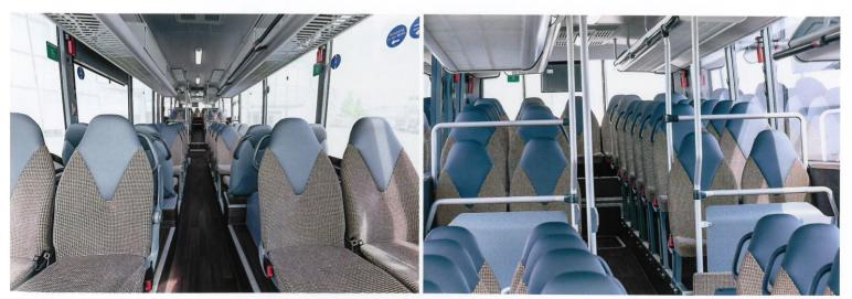
Bis zur zweiten Tür ist der Mittelgang stufenlos, die Sitze sind dort auf 190 mm hohen Podesten angeordnet. Den Fahrgästen im vorderen Bereich stehen für ihre Mitbringsel Gepäckablagen zur Verfügung.
