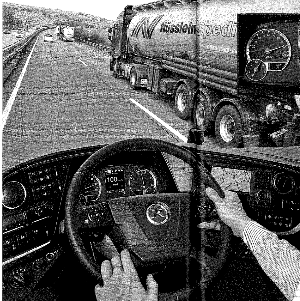
◀ ▲ Wirksames Gefälle: Trotz Sollgeschwindigkeit 95 überholen wir den Tankwagen mit Tempo 100. Der Bus befindet sich im Schubetrieb, der Retarder ist begleitend im Einsatz Fotos: Göngler (3)
