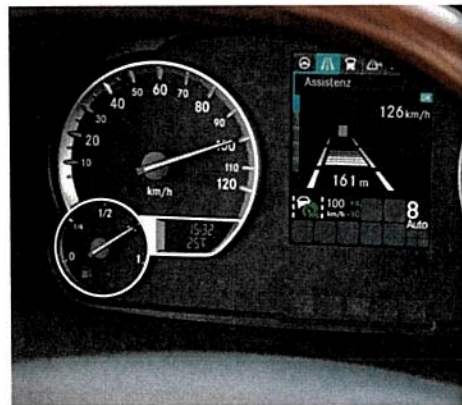
Gut zu erkennen ist das aktive PPC-System am grünen Sym
