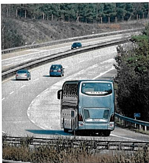
Vor dem Anstieg nimmt PPC mehr Schwung, um Schaltungen im Berg zu vermeiden.
