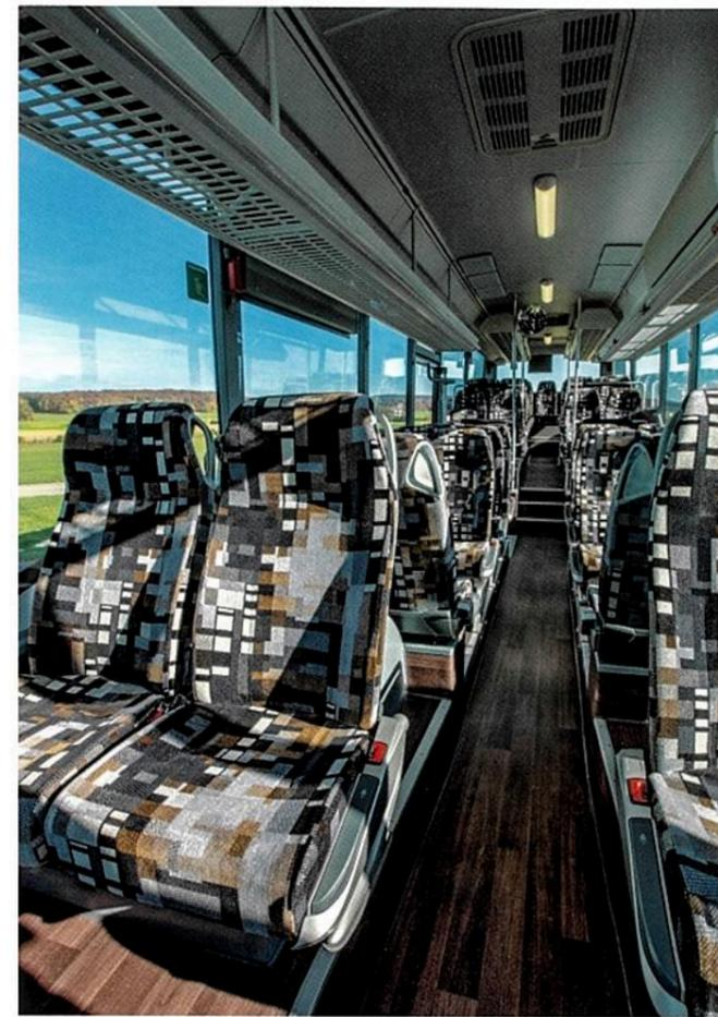
Riesenraum: Im Niederflurbereich beträgt die Stehhöhe 2,62 Meter. Hinten das Hochbodenheck mit einer Raumhöhe von 2,17 Metern.
